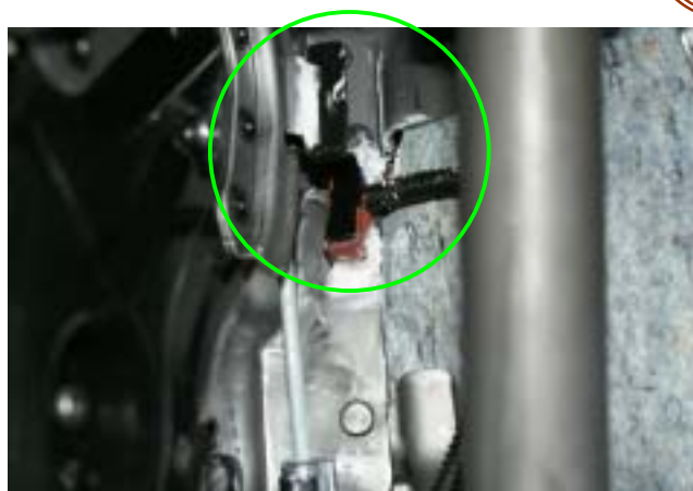
サイドブレーキが掛かっている状態(車両停止状態) (サイドブレーキスイッチは導通無しの状態)
